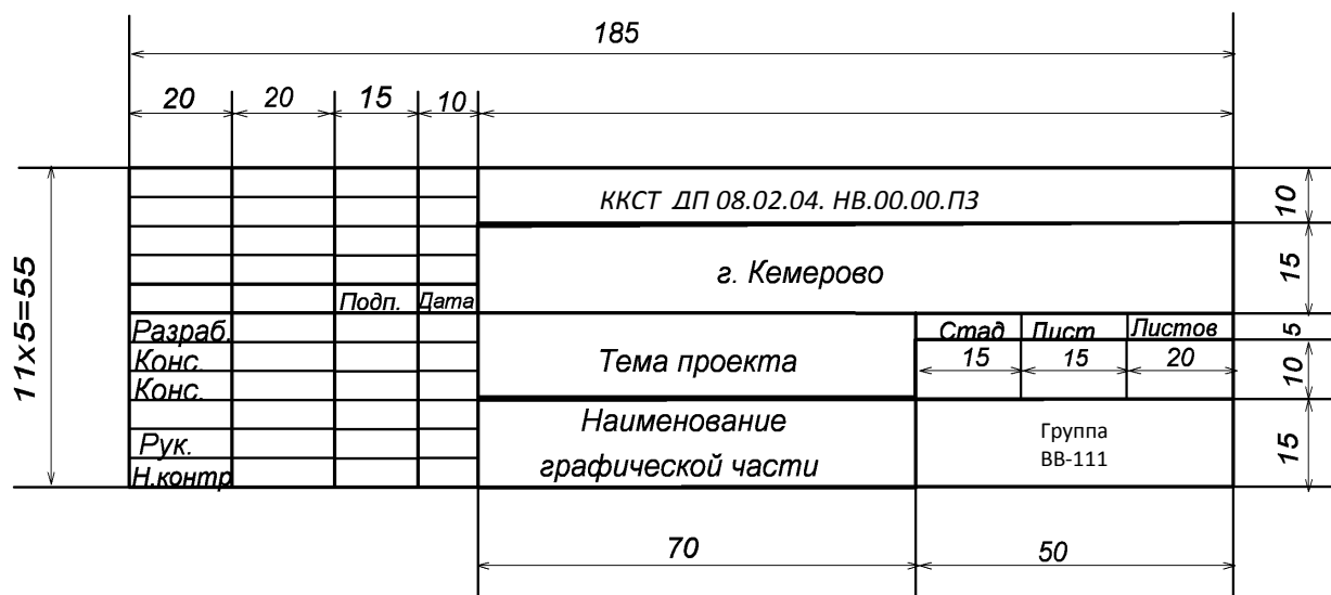
Рисунок Г1 Форма и размеры основной надписи для первых графических листов
